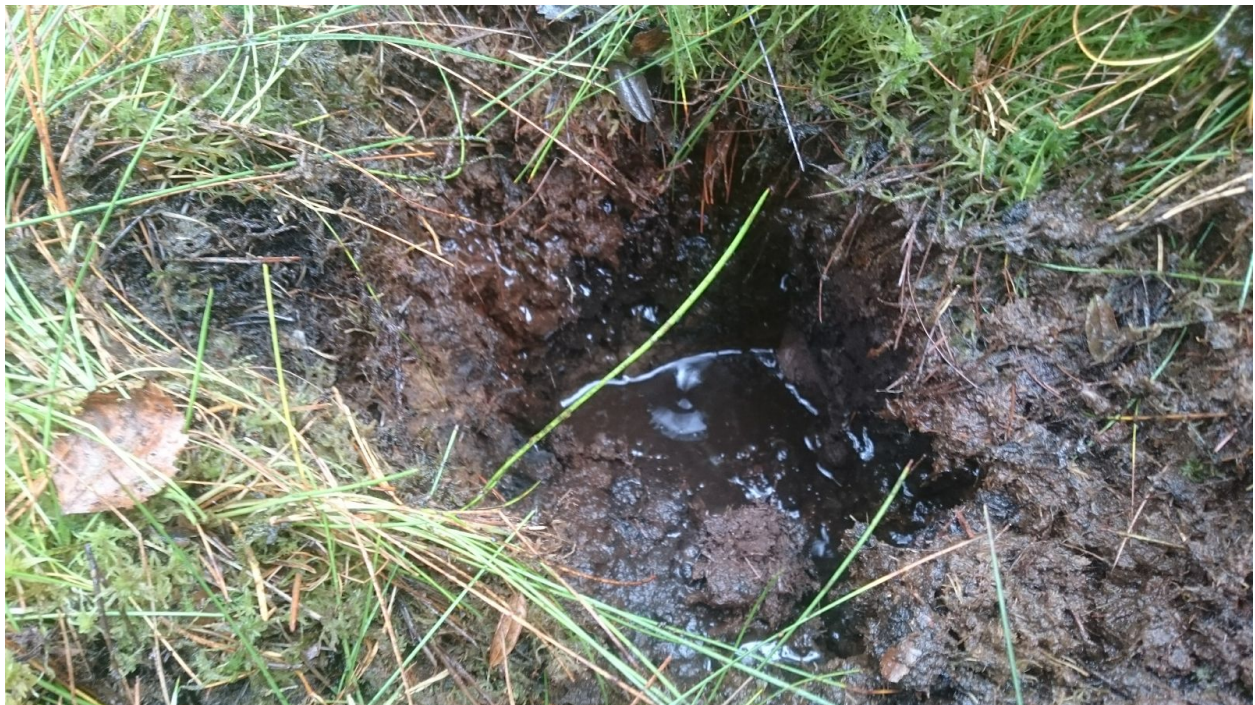
Pilt 9. Šurf FE13 madalsoos sootee kohal. Šurfis tulid välja teekonstruktsiooni palgid, kuid need jäid alla veepiiri.
